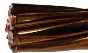
Taglio con forbici o tronchesine ordinarie. Ricordarsi di limare per rimuovere eventuali sbavature del metallo, seguendo il verso della cordatura.
