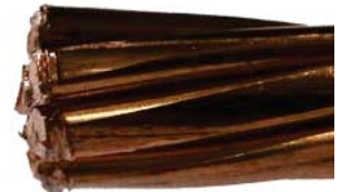
Taglio con forbici o tronchesine ordinarie. Ricordarsi di limare per rimuovere eventuali sbavature del metallo, seguendo il verso della cordatura.
